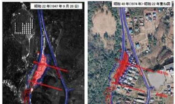
写真-1 米軍の写真(左1947年)切土崩落範囲(右1974年)
