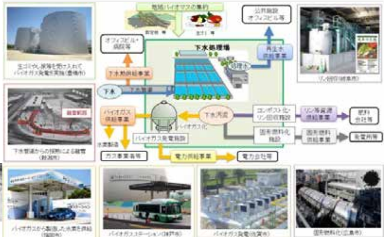
図-4 下水道が有する多様な資源・エネルギー (国交省 HP)
