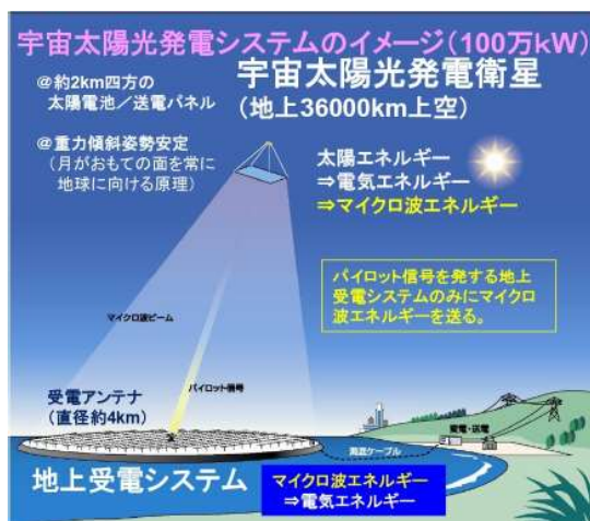
図-1 SSPS のイメージ (100 万 kW)
